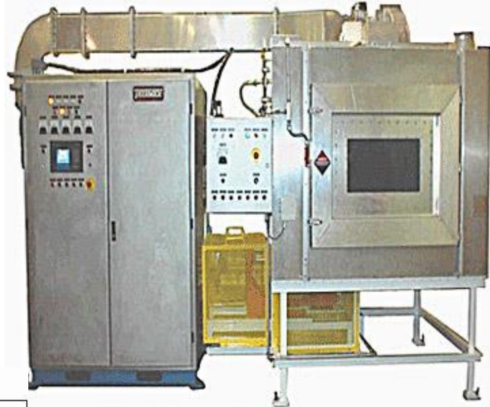
75 Horno de lote KW conectado a un generador 915 MHz MW
